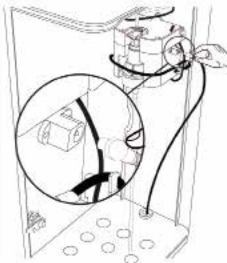
12) Placering av 5l desinfektionsbehållare på hylla. För slangens genom behållarens lock, och vidare ner i behållaren.
